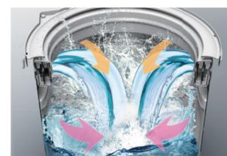
水を滝のように勢よく、落下させるタテ水流と洗濯槽の回転によるヨコ水流が組み合わさり、立体的な水流を生み出し、衣類をしっかりと洗い上げます。
