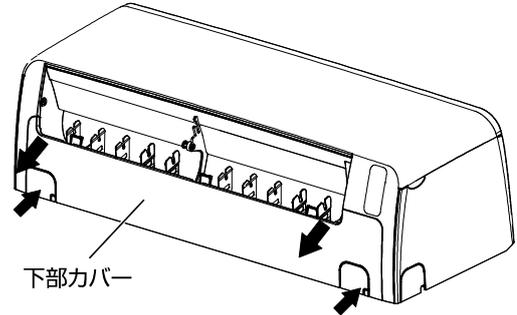
b. 下部カバーの下部を矢印の方向に押しながら、上部を手前に引き、取りはずす
