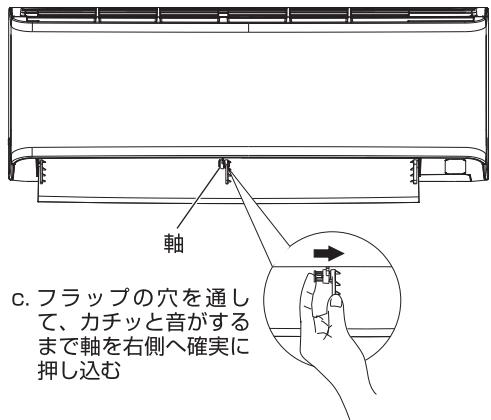
c. フラップの穴を通して、カチッと音がするまで軸を右側へ確実に押し込む
