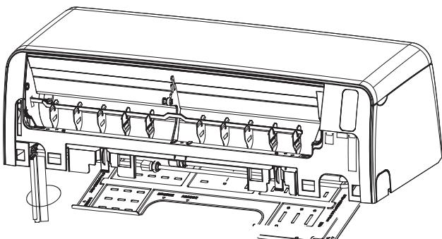
④ 下部カバーを元の位置に確実に取り付け、ネジで止める
