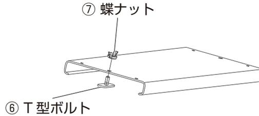
②断面図を参考に、T型ボルトをパネルBやDの溝にスライドさせて挿入し、長さを調整したあと蝶ナットを閉める
