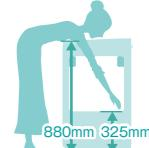
**その他** 水平設置が一目で分かる水準器付き / 左右・後・真下の4方向排水ホース対応(注1)
