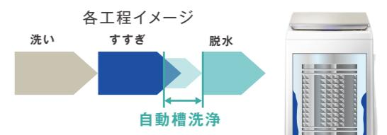
自動槽洗浄をセットしておけば、毎回の洗濯ですすぎの際に自動で槽を洗浄。
