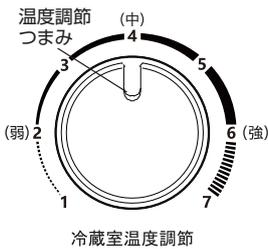
冷凍冷蔵庫全体の冷却運転の強さを調節します。
