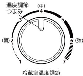
冷凍冷蔵庫全体の冷却運転の強さを調節します。
