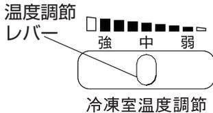
冷凍室と冷蔵室の冷気の配分を調節します。
