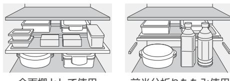
冷蔵室には折り畳み式の棚も付属しています。必要に応じ押し込むことができます。はじめに手前側の端を少し持ち上げ(①)、矢印で示すように内側に押します(②)。元に戻す場合は、逆の手順で行います。
