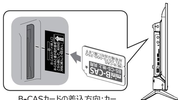
B-CASカードの差込方向: カード切り欠き部分が下になるように、B-CASカードをカードスロットに挿入してください。「カチッと」音がするまで差し込みます。
