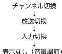
各切換モードでジョイスティックを左右に倒すと、それぞれの項目の切り換えができます。
