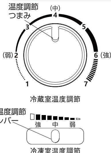
冷凍冷蔵庫全体の冷却運転の強さを調節します。
