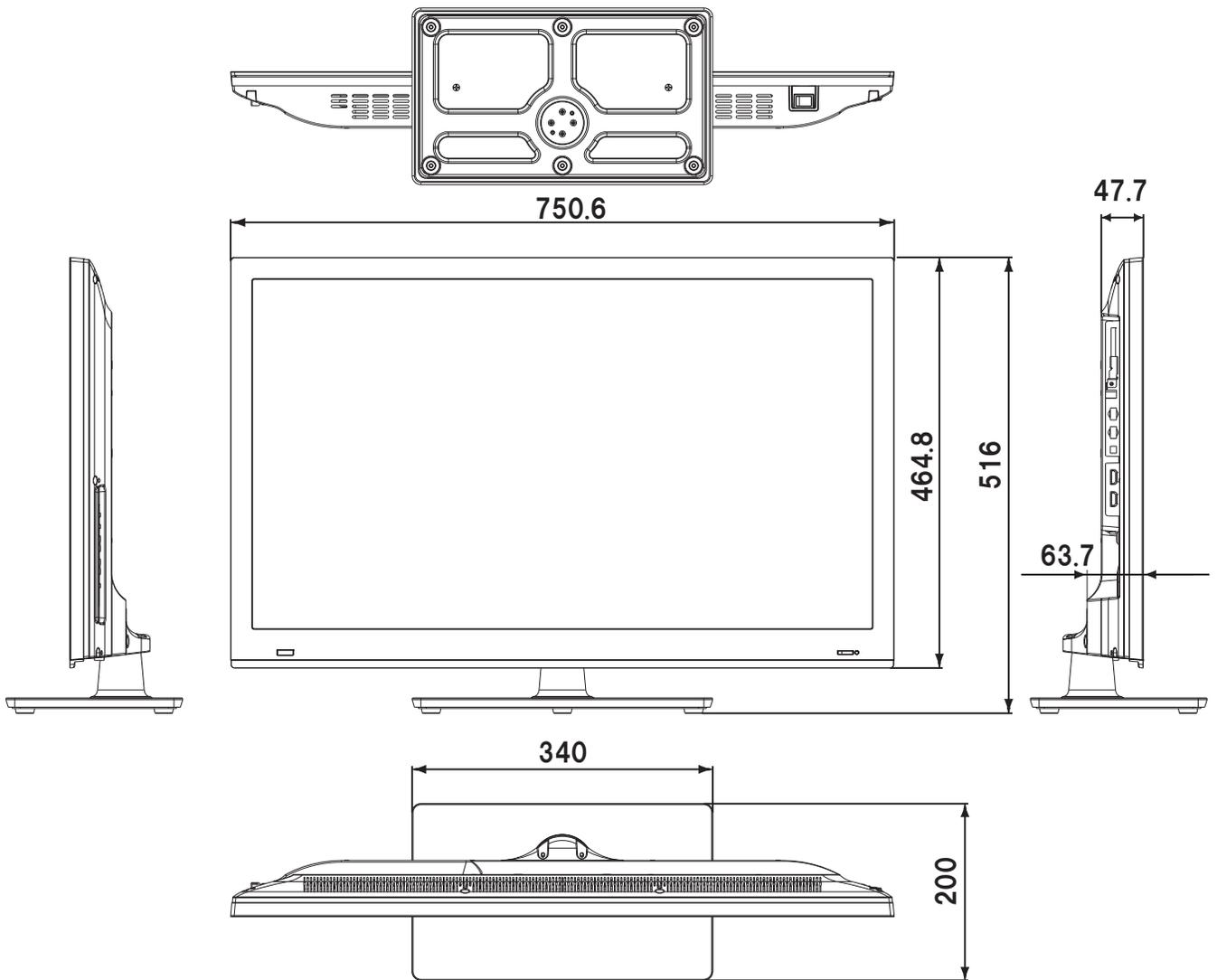
直付けの電源コードがこの位置から出てきますので、金具を取り付けるときは避けて取り付けてください。
