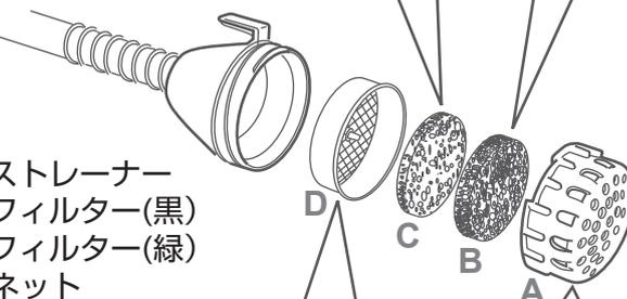
④ 取り付ける場合は、必ず右図の並び方通りに部品を戻し、ストレーナーを右側に回して取り付ける
