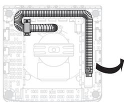
工場出荷時、排水ホースは洗濯機の内側に固定されています。ご使用前に排水管を洗濯機の内側から取り出します。
