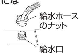
● 給水ホースのナットを水平でなく斜めに締めると、給水口のねじが壊れる場合があります。
