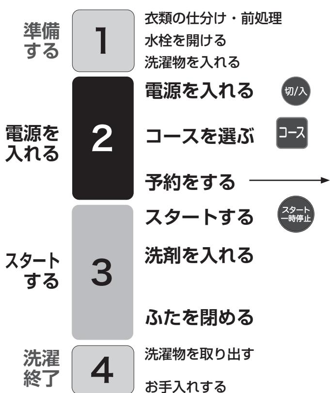
**予約** を押すごとに1時間単位で設定できますが、洗濯時間により最初の表示が変わります。
