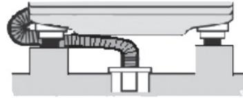
排水エルボや排水ホースが底カバーに接触する場合は、真下排水パイプと市販の高さ調整脚を使用して調整してください。
