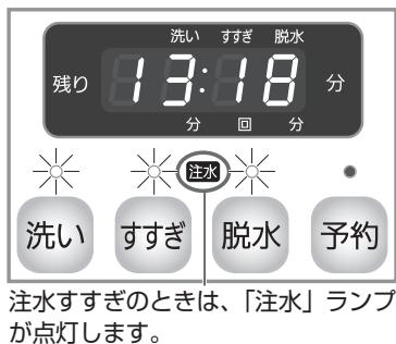
**【脱水】**ボタンを押すごとに、脱水時間が1分から8分まで変わります。さらに押すと上部のランプが消灯し脱水がなくなります。（洗い・すすぎ・脱水のいずれかの設定が必要です。すべての設定解除はできません）
