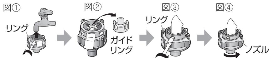
3. 水栓出口に垂直に押しつけ、水栓出口がリングの中心となるよう、リングのねじ(4本)を均等にしっかりと締め付ける(図③)
