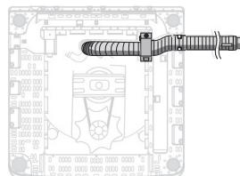
工場出荷時、排水ホースは洗濯機の内側に固定されています。ご使用前に排水管を洗濯機の内側から取り出します。
