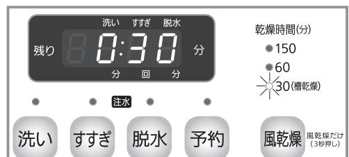
風乾燥だけを設定する場合は、ボタンを3秒間押します。上図のように0:30と表示され風乾燥以外のランプが消灯します。(☞ 22ページ)
