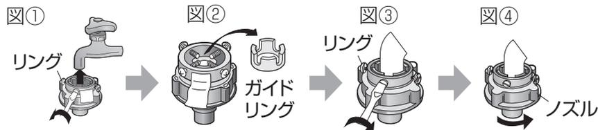
3. 水栓出口に垂直に押しつけ、水栓出口がリングの中心となるよう、リングのねじ(4本)を均等にしっかり締め付ける(図③)
