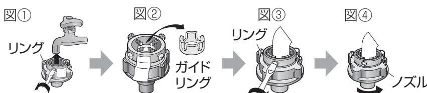
3. 水栓出口に垂直に押しつけ、水栓出口がリングの中心となるよう、リングのねじ(4本)を均等にしっかりと締め付ける(図③)
