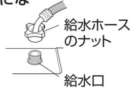
● 給水ホースのナットを水平でなく斜めに締めると、給水口のねじが壊れる場合があります。
